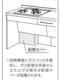
○加熱機器にガスコンロを選択し、ガス配管を床面から立ち上げる場合は配管カバーが設置されます。
